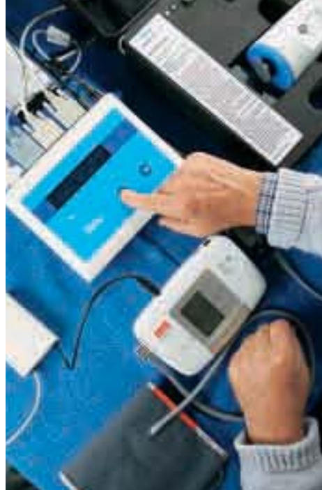
...und schickt per Knopfdruck via Telefonnetz sämtliche Werte ins Kontrollzentrum...
